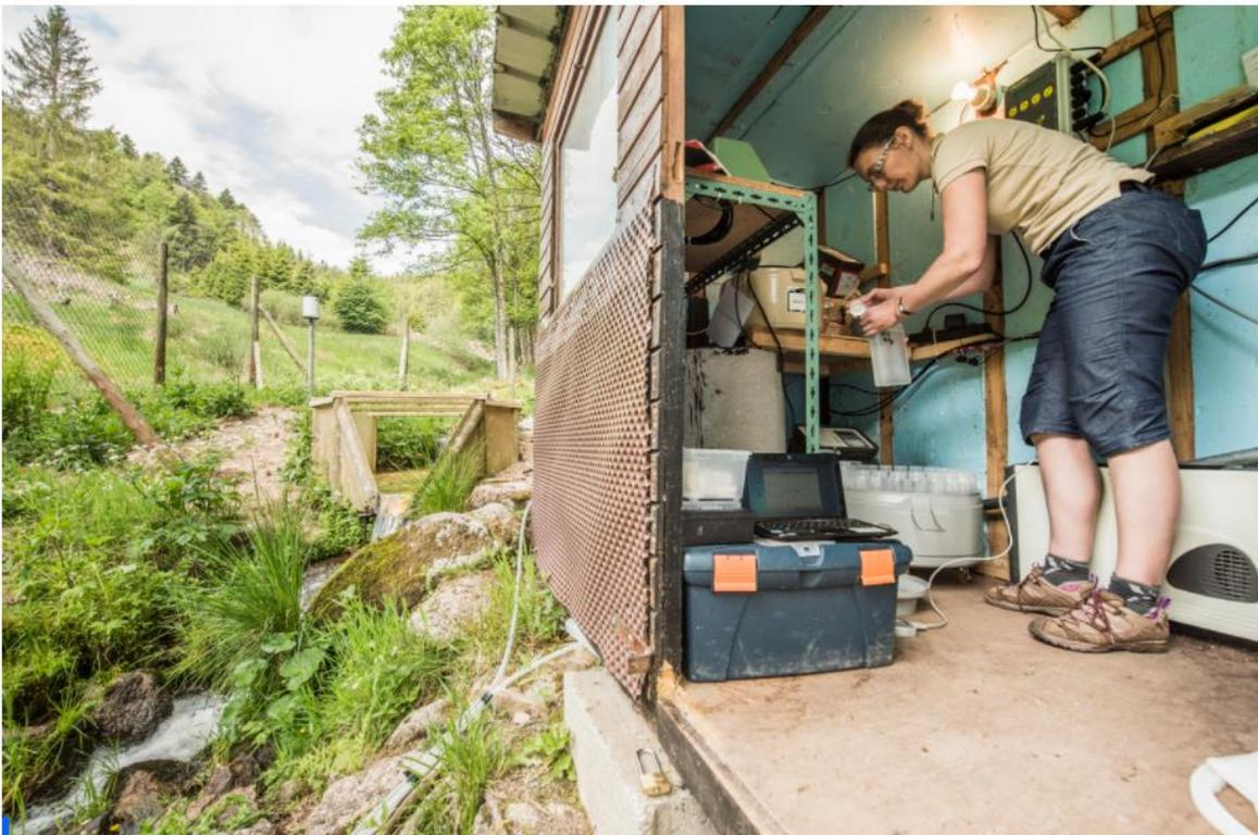
Récupération des prélèvements automatiques d'eau du ruisseau du bassin versant du Strengbach, dans le massif vosgien. Ces mesures sont effectuées au sein de l'Observatoire Hydro-Géochimique de l'Environnement (OHGE). Les chercheurs y étudient les réponses du milieu naturel face aux perturbations naturelles et anthropiques telles que la pollution atmosphérique, l'exploitation forestière ou plus généralement les changements climatiques. © Hubert RAGUET/LHYGES/IPGS/OHGE /CNRS Photothèque
