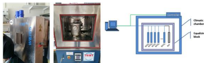
Fig. 2 - Campagne de mesure effectuée au LMD (Ecole Polytechnique) pour mieux caractériser les incertitudes de mesures de la sonde de température de la sonde M10 (action Météomodem et IPSL).
